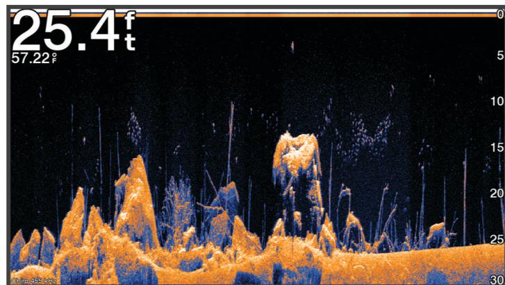
Traditionelle Geber senden einen konischen Kegel. Die Garmin ClearVü Echolottechnologie sendet einen Kegel, der dem Strahl in einem Kopiergerät ähnelt. Der Kegel produziert ein klares, realitätsnahes Bild der Ansicht unter dem Schiff.
