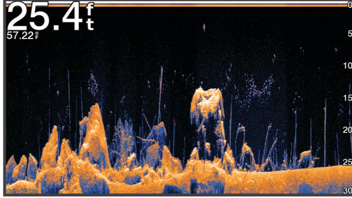
تُصدر المحوّل التقليديّة شعاعاً مخروطياً. تصدر تقنية سونار Garmin ClearVü الخاص بالمسح شعاعاً شبيهاً بشكل الشعاع الذي تصدره آلة النسخ. ويوفر هذا الشعاع صورةً أكثر وضوحاً ودقةً لما يوجد أسفل المركب.
