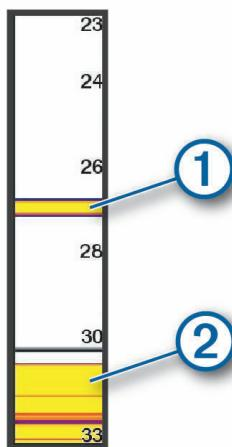
A-scope di atas memperlihatkan pantulan ikan ① dan pantulan bagian dasar dengan mulus ②.
