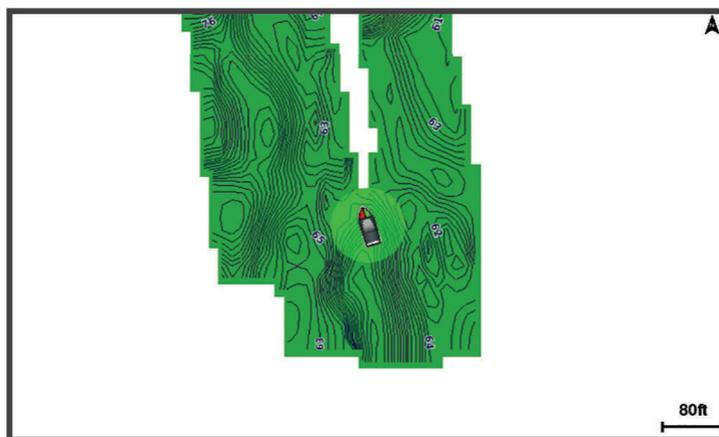
Un cercle vert indique que la profondeur et la position GPS sont bonnes et que la vitesse est inférieure à 16 km/h (10 mph). Un cercle jaune indique que la profondeur et la position GPS sont bonnes et que la vitesse se situe entre 16 et 32 km/h (entre 10 et 20 mph). Un cercle rouge indique que la profondeur et la position GPS sont mauvaises et que la vitesse est supérieure à 32 km/h (20 mph).
