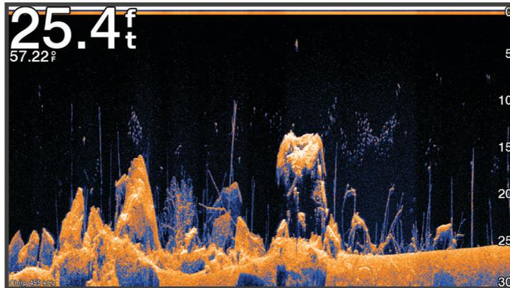
Les sondes classiques émettent un faisceau conique. La technologie du sondeur à balayage Garmin ClearVü émet un faisceau dont la forme ressemble au faisceau d'une photocopieuse. Ce faisceau permet d'obtenir une image plus claire de la colonne d'eau.
