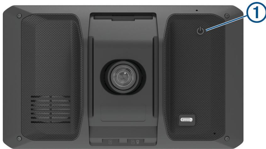
لتعيين الجهاز إلى وضع توفير الطاقة، اضغط على زر الطاقة فيما يكون الجهاز قيد التشغيل. في وضع توفير الطاقة، تتوقف الشاشة عن التشغيل ولا يستخدم الجهاز سوى قدرًا ضئيلًا من الطاقة، ولكن يصبح نشطًا على الفور لإتاحة الاستخدام.
