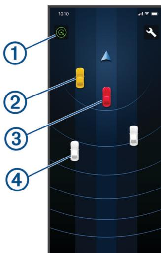
L'icône d'état ① indique l'état du capteur radar. La position des véhicules change leur couleur d'affichage en fonction du niveau de danger. Un véhicule jaune ② indique qu'un véhicule approche dans votre angle mort à gauche ou à droite de votre moto. Un véhicule rouge ③ indique qu'un véhicule s'approche rapidement ou présente un danger. Dans ces cas, le témoin d'alerte arrière clignote trois fois en rouge. Un véhicule gris ④ indique qu'un véhicule approche à distance.
