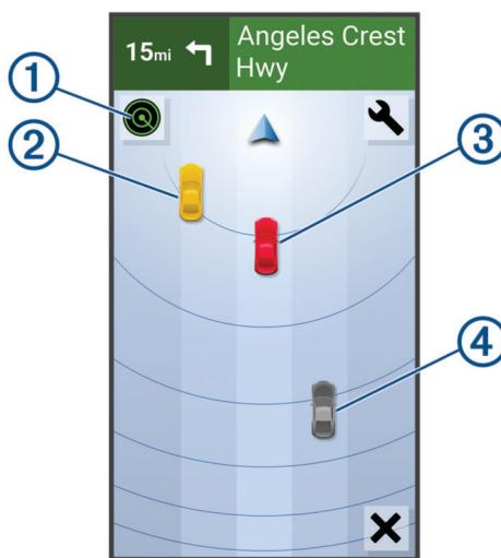
La position des véhicules change leur couleur d'affichage en fonction du niveau de danger. L'icône d'état ① indique l'état du capteur radar. Un véhicule jaune ② indique qu'un véhicule approche dans votre angle mort à gauche ou à droite de votre moto. Un véhicule rouge ③ indique qu'un véhicule s'approche rapidement ou présente un danger. Dans ces cas, le témoin d'alerte arrière clignote trois fois en rouge. Un véhicule gris ④ indique qu'un véhicule approche à distance.
