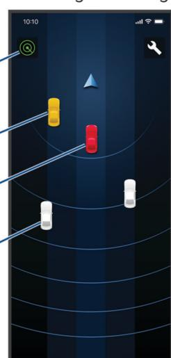
Das Statussymbol ① zeigt den Status des Radarsensors an. Die Farbe der Fahrzeugpositionen ändert sich basierend auf der Gefahrenstufe. Ein gelbes Fahrzeug ② zeigt an, dass sich ein Fahrzeug im toten Winkel auf der linken oder rechten Seite des Motorrads nähert. Ein rotes Fahrzeug ③ zeigt an, dass sich ein Fahrzeug schnell nähert oder eine Gefahr darstellt. In diesem Fall blinkt das rückwärtige Warnlicht dreimal rot. Ein graues Fahrzeug ④ zeigt an, dass sich ein Fahrzeug aus der Ferne nähert.
