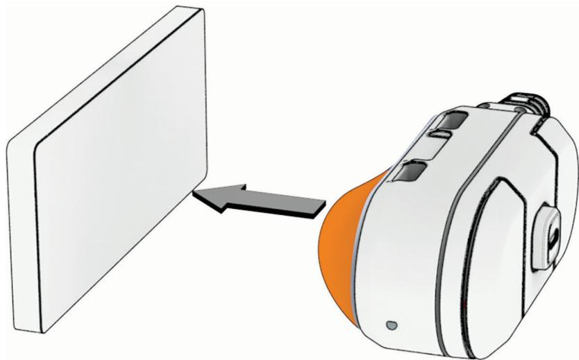
**TIPP:** Der Klebstoff haftet außergewöhnlich stark. Die Anzeigeleuchte muss zunächst ordnungsgemäß positioniert und ausgerichtet sein, bevor der Klebstoff mit der Montagefläche in Berührung kommen darf.
