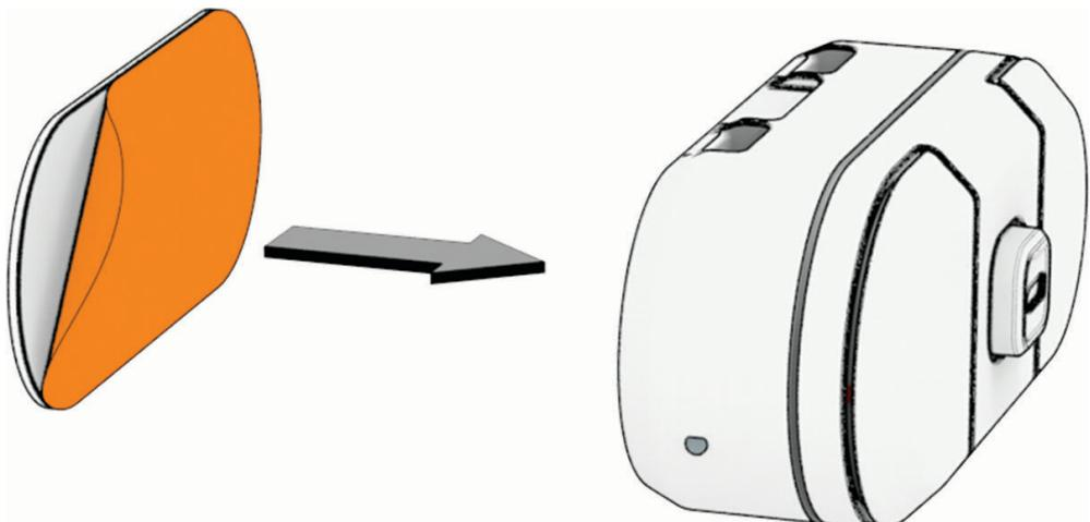
**TIPP:** Der Klebstoff haftet außergewöhnlich stark. Die Anzeigeleuchte muss zunächst ordnungsgemäß positioniert und ausgerichtet sein, bevor der Klebstoff mit der Montagefläche in Berührung kommen darf.
