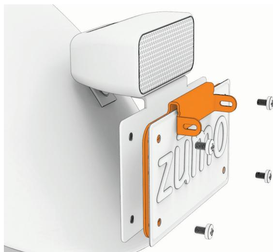
**HINWEIS:** Einige Nummernschilder werden möglicherweise nur mit zwei Schrauben befestigt. Sofern dies möglich ist, sollten Sie jedoch vier Schrauben verwenden.
