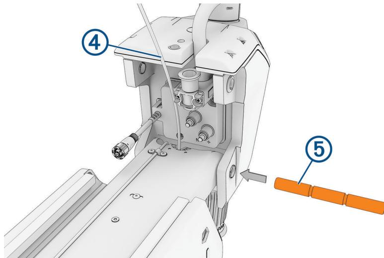
5 Ziehen Sie das Lenkservogehäuse nach oben, und drücken Sie gleichzeitig den Lagerstift **⑤** durch das Gehäuse und das Gelenk, um es zu fixieren.
