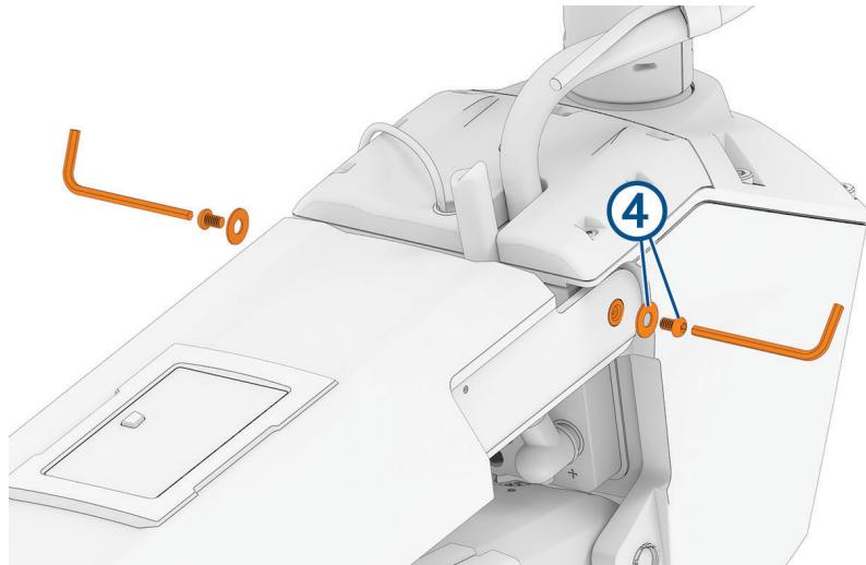
**HINWEIS:** Damit der Stift ordnungsgemäß gesichert ist, sollten Sie zwei Inbuseinsätze oder -schlüssel verwenden, damit sich der Pin beim Anziehen der Schrauben nicht dreht.
