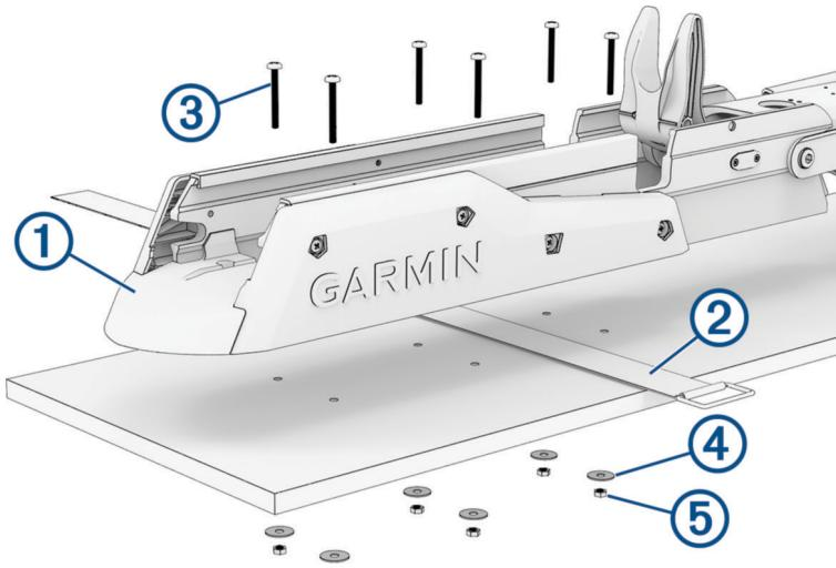
**HINWEIS:** Auf der Backbordseite am Bugende der Basis sind zwei Montagelöcher angebracht. Abhängig vom Installationswinkel und von der Form des Rumpfes können Sie wählen, welches Montageloch Sie verwenden möchten.
