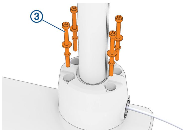
Al sustituir el transductor, desecha estos tornillos, arandelas y juntas circulares. El kit de sustitución de transductor incluye piezas nuevas.
