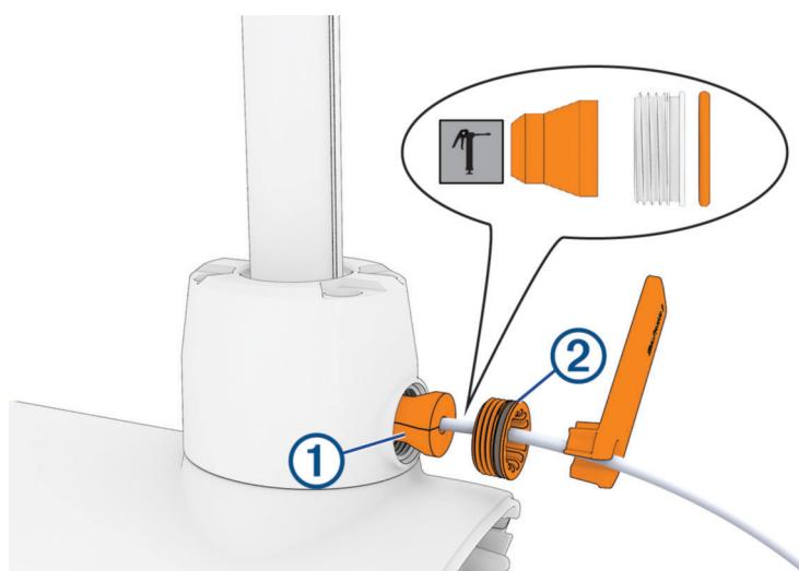
**5** Mientras mantienes el pasamuros alineado con la marca del cable del transductor, tira con cuidado del cable sobrante a través de la parte superior del eje hasta que el pasamuros encaje en el orificio de la base del eje.
