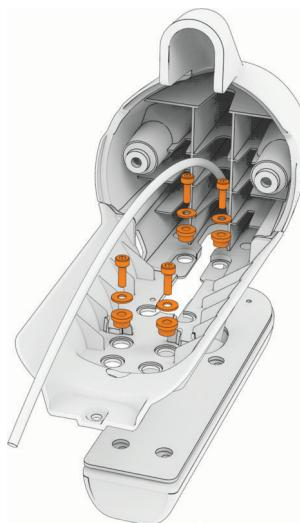
Al sustituir el transductor, desecha estos tornillos, arandelas y cojinetes. El kit de sustitución de transductor incluye piezas nuevas.
