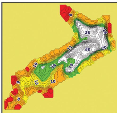
Зеленый круг обозначает хорошее качество регистрации глубины, высокую точность определения местоположения по GPS, а также хорошую скорость. Желтый круг обозначает хорошее качество регистрации глубины и высокую точность определения местоположения по GPS, но скорость немного выше требуемой. Красный круг указывает на недостаточную информацию о глубине, низкую точность определения местоположения по GPS или слишком высокую скорость.
