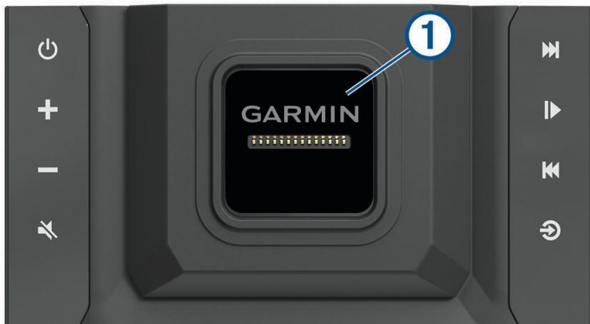
**1** Магнитная док-станция для дисплея Vieu RV 750. Заряжает дисплей и устанавливает пользовательский интерфейс дисплея в режим док-станции.
