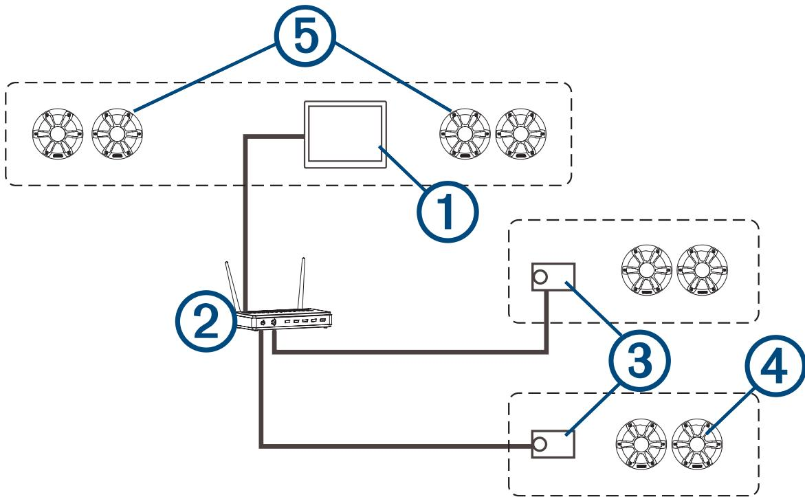
上の画像では、1台の Vizio RV 750 ステレオ ① がワイヤレスルーター ② および 2台の Apollo SRX400 ゾーンステレオ ③ に接続されています。2台の FUSION PartyBus ステレオゾーンステレオは、FUSION PartyBus ステレオからソースをストリーミングできます。
