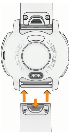
**HINWEIS:** Vergewissern Sie sich, dass das Armband sicher befestigt ist. Die Verriegelung sollte über dem Stift einrasten.
