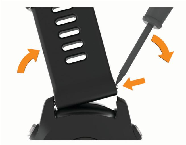
**NOTA:** verificare che il cinturino sia fissato. Il perno dell'orologio deve essere allineato ai fori sul dispositivo.
