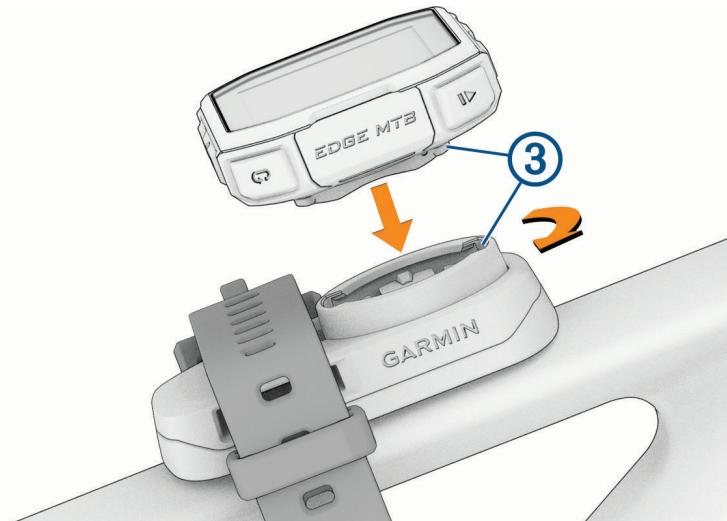
10 Слегка надавите и поверните велокомпьютер по часовой стрелке, чтобы он встал на место.
