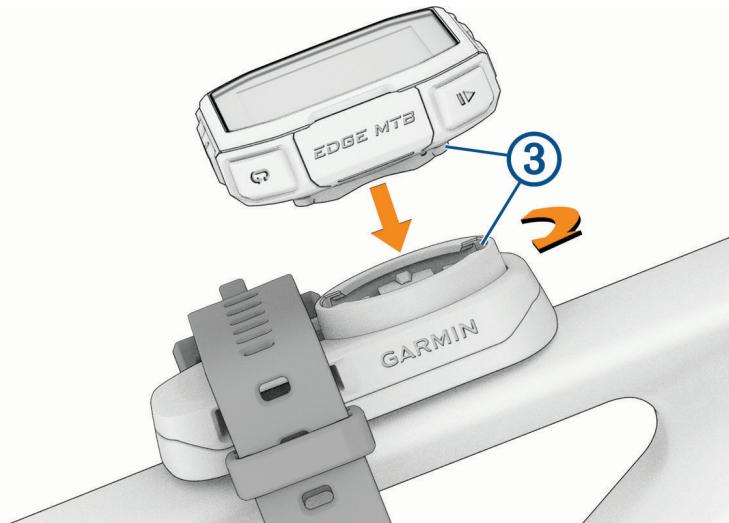
**10** Premere leggermente e ruotare il ciclocomputer in senso orario finché non scatta in posizione.
