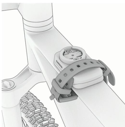
**9** Allineare le linguette sul retro del ciclocomputer Edge alle scanalature della staffa per manubrio **③**.
