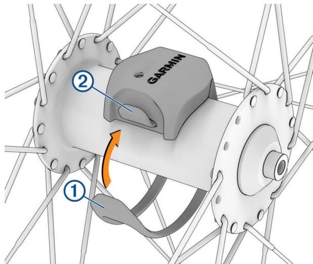
El sensor puede quedar inclinado si se instala en un buje asimétrico. Esto no afecta al funcionamiento.
