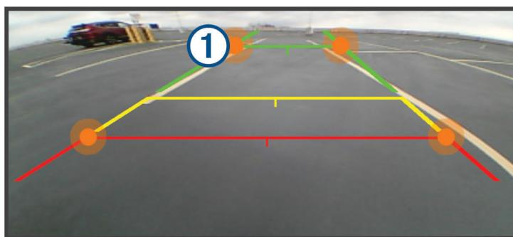
**4** Se necessario, riposizionare il veicolo con l'altro lato allineato a un marciapiede o alle righe di un parcheggio e ripetere la procedura di allineamento.
