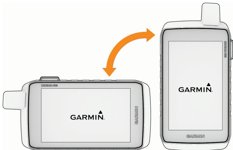
**OBSERVAÇÃO:** ao usar os recursos inReach do seu dispositivo Montana 700i/710i/750i/760i, use-o no modo vertical (retrato), com a antena apontada para o céu.
