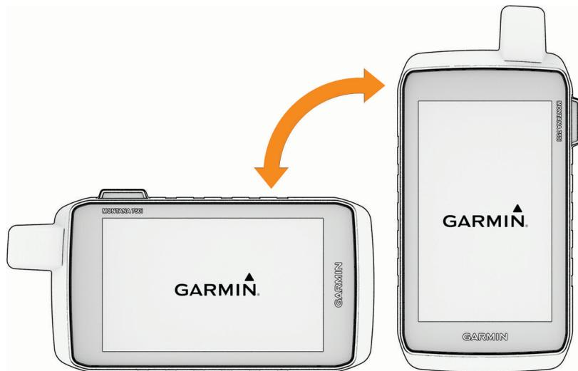
**HINWEIS:** Wenn Sie die inReach Funktionen des Montana 700i/710i/750i/760i Geräts nutzen, sollten Sie das Gerät im vertikalen Modus (Hochformat) verwenden, wobei die Antenne auf den Himmel ausgerichtet ist.
