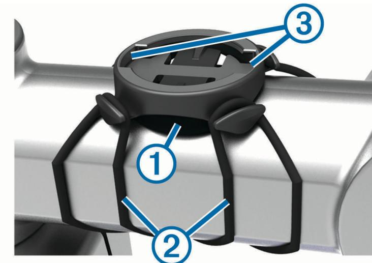
**3** Setzen Sie die Fahrradhalterung auf den Lenkervorbau auf.
