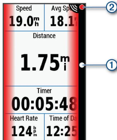
Die Fahrzeugpositions-LED ① rückt in der Lichteiste immer weiter nach oben, je näher sich das Fahrzeug Ihrem Fahrrad nähert. Die Gefahrenstufen-LED ② ändert die Farbe basierend auf der möglichen Gefahrenstufe. Grün bedeutet, dass kein Fahrzeug erkannt wurde. Gelb bedeutet, dass sich ein Fahrzeug nähert. Rot bedeutet, dass sich ein Fahrzeug sehr schnell nähert.
