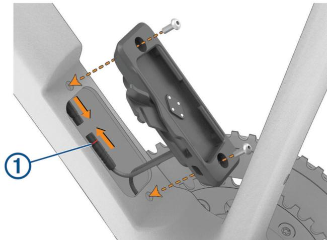
**HINWEIS:** Berühren oder bewegen Sie nach Möglichkeit nicht den Dichtungsring ①, um sicherzustellen, dass die Kabel ordnungsgemäß verbunden und abgedichtet sind.
