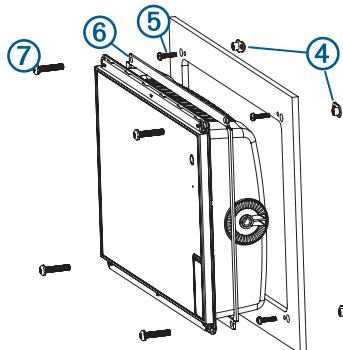
**17** Fissare le piastrine filettate alla superficie di montaggio serrando le viti in ferro più piccole **⑤** nei fori più piccoli.
