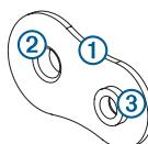
Le trou le plus petit ③ sur la platine doit être aligné sur le plus petit trou du modèle.
