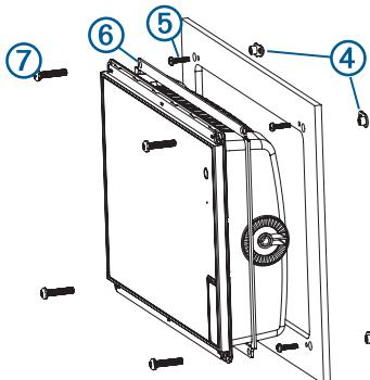
**17** Fixez les platines à la surface de montage en plaçant les petites vis mécaniques fournies **⑤** dans les petits trous.
