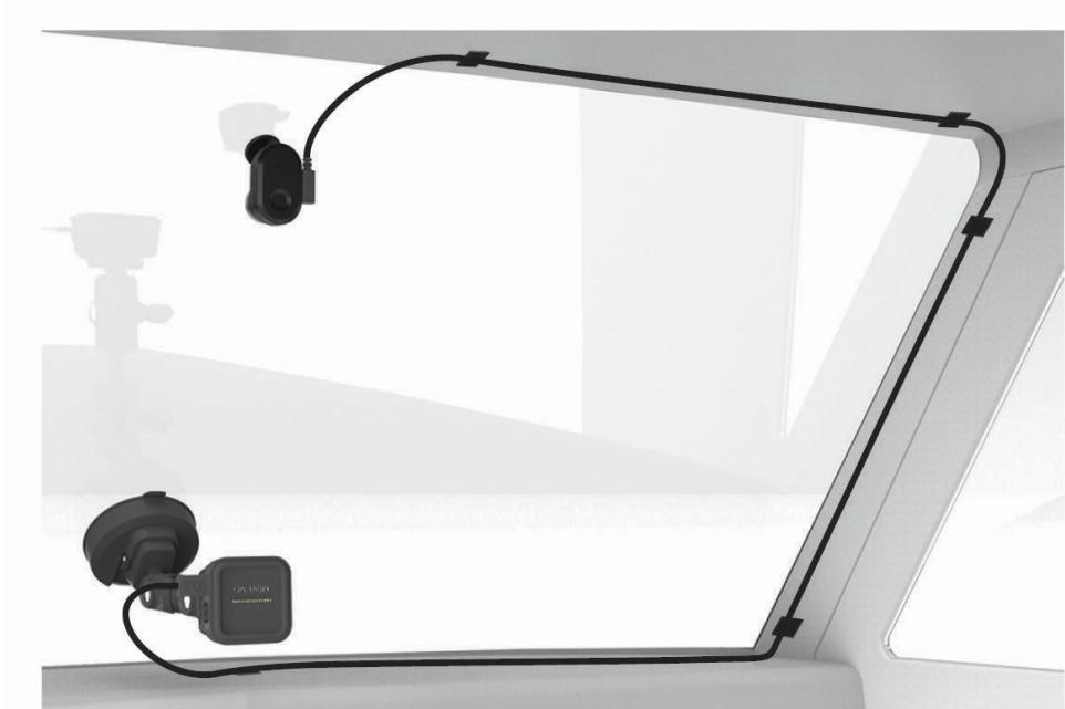
ケーブルは、見えない場所に配線するように設計されています。ケーブルを隠すには、フロントガラス、ドアフレーム、またはダッシュボードに沿って車内の端の部分に隠すように配線します。
