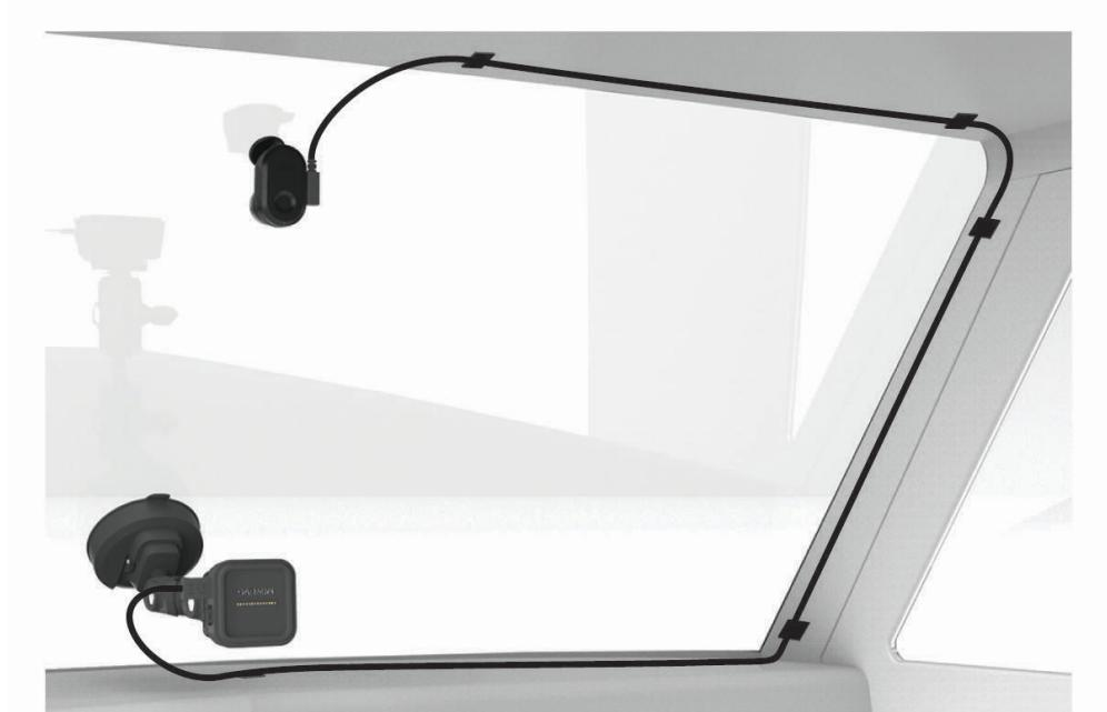
El cable está diseñado para colocarlo de forma que no se vea. Para ocultar el cable, colócalo a lo largo de la moldura del parabrisas del vehículo, del marco de la puerta o del salpicadero.
