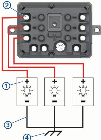
**2** Priklučite negativnu ili žicu uzemljenja **③** na neobojani vijak za uzemljenje **④** na okviru vozila, na blok razdjelnika uzemljenja ili izravno na negativni priključak akumulatora.
