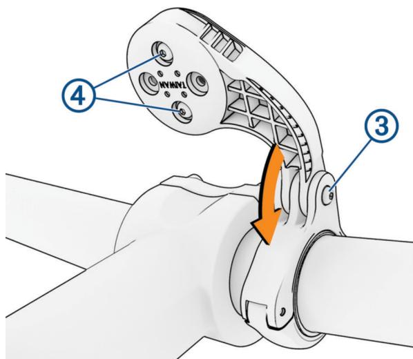
**6** Per cambiare l'orientamento della staffa, utilizzare una chiave a brugola da 2 mm per rimuovere le due viti dal lato posteriore del supporto **4**, rimuovere e ruotare il connettore e riposizionare le viti.
