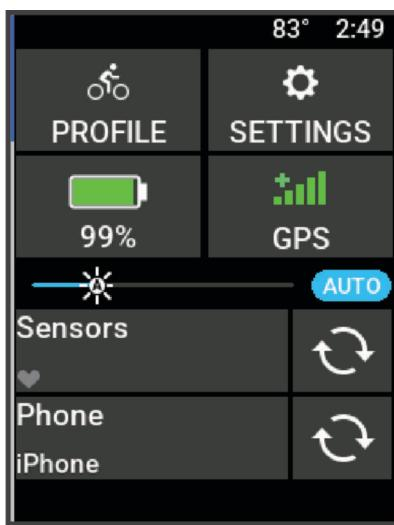
Viene visualizzato il widget dello stato. Un'icona lampeggiante indica che il dispositivo sta cercando un segnale. Un'icona fissa indica che il segnale è stato trovato o che il sensore è connesso. Per modificare le impostazioni, selezionare un'icona.
