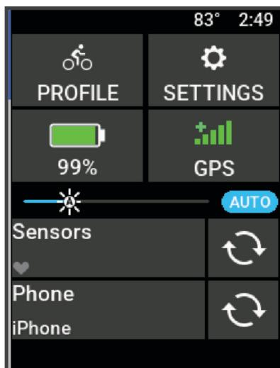
Le widget du statut s'affiche. Une icône clignotante signifie que l'appareil recherche un signal. Une icône fixe signifie que le signal a été trouvé ou que le capteur est connecté. Vous pouvez sélectionner n'importe quelle icône afin de modifier les paramètres.
