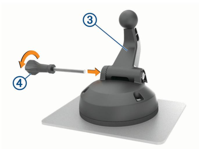
6 将指旋螺钉 ④ 插入固定装置，然后拧紧以固定球形固定装置臂。
