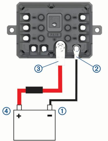
2 将地线的小环端连接到设备上的 GND 端子 ②。
