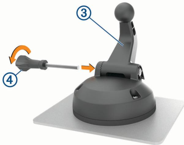
**6** Insira o parafuso **④** no suporte e aperte-o para fixar o braço de suporte esférico.
