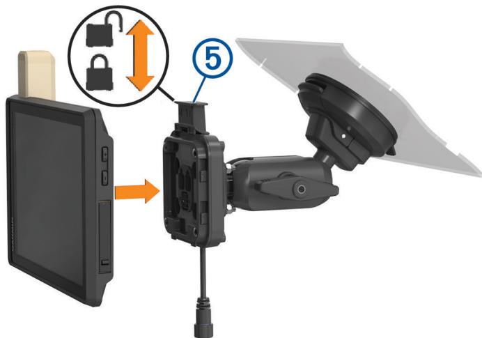
**9** Нажмите на фиксатор **⑤**, чтобы зафиксировать устройство в креплении.
