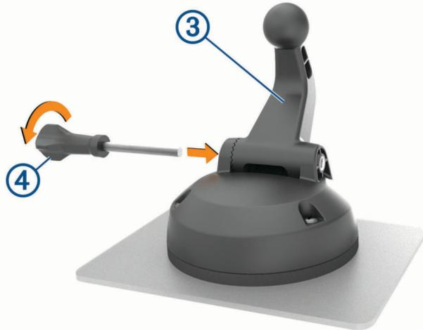
6 Setzen Sie die Flügelschraube **(4)** in die Halterung ein, und ziehen Sie sie fest, um den Arm der Kugelhalterung zu befestigen.
