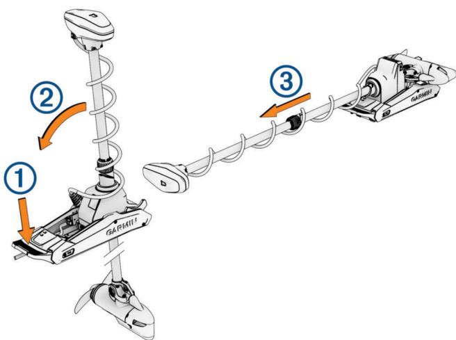
**OBSERVAÇÃO:** o motor deve virar automaticamente para 90° para recolher. O lado de armazenamento da hélice pode ser configurado no menu de configurações.
