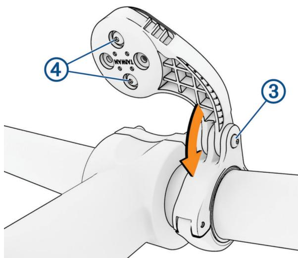
**6** Per cambiare l'orientamento della staffa, utilizzare una chiave a brugola da 2 mm per rimuovere le due viti dal lato posteriore del supporto **④**, rimuovere e ruotare il connettore e riposizionare le viti.
