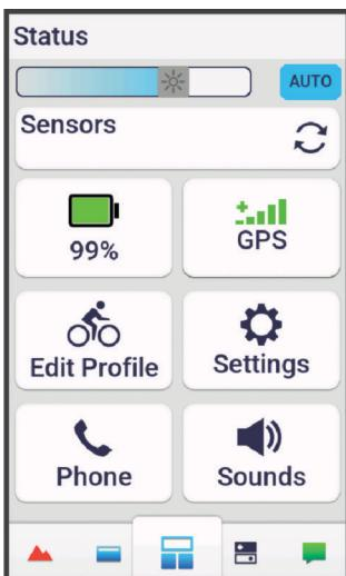
Viene visualizzato il widget dello stato. Un'icona lampeggiante indica che il dispositivo sta cercando un segnale. Un'icona fissa indica che il segnale è stato trovato o che il sensore è connesso. Per modificare le impostazioni, selezionare un'icona.
