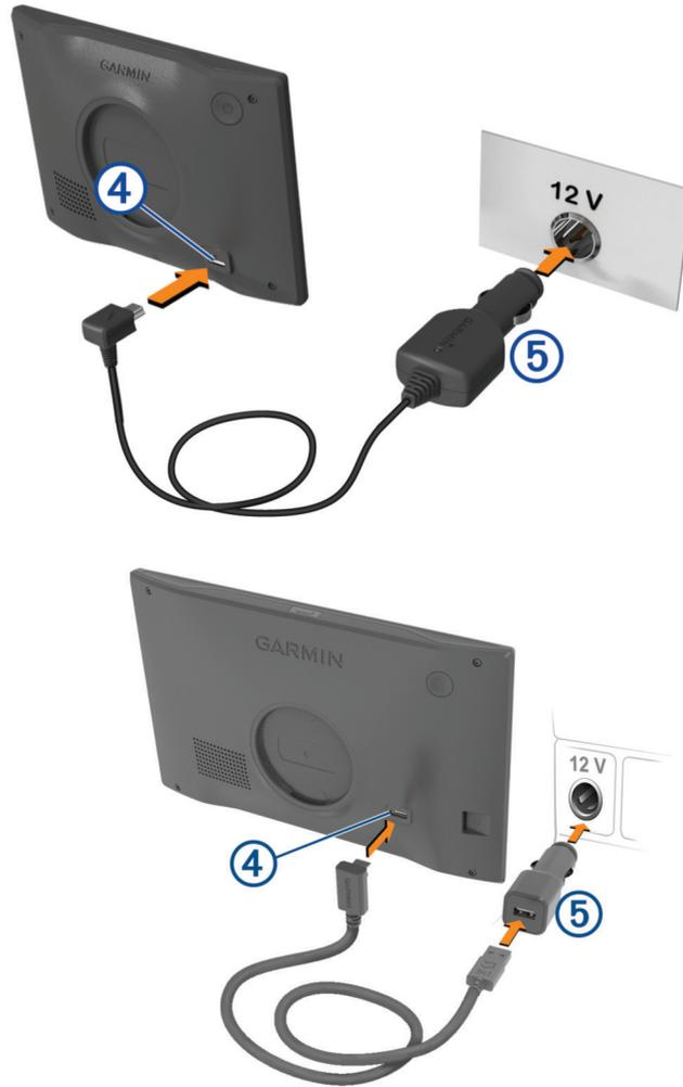
4 如有必要，将车辆电源线的另一端插入车辆电源适配器 ⑤ 中。
