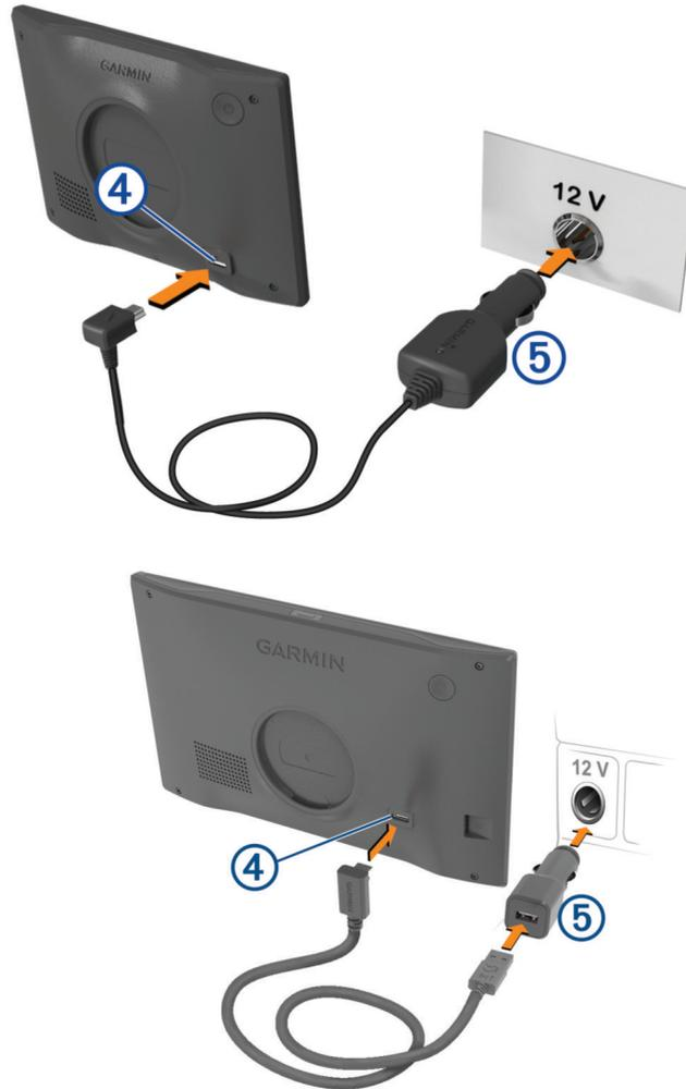
4 Stecken Sie das andere Ende des KFZ-Anschlusskabels bei Bedarf in den KFZ-Adapter ⑤.
