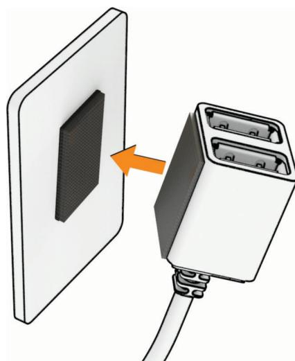
8 Conecta el cable de alimentación USB del dispositivo Garmin Dash Cam a un puerto USB del Constant Power Cable.
