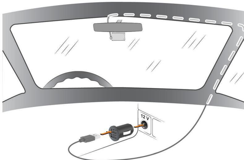
El cable corto está diseñado para ir hacia abajo hasta la fuente de alimentación del vehículo.
