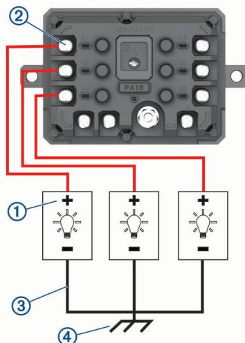
2 将负极线或接地线 ③ 连接到车辆框架上未上漆的接地柱 ④、接地分配块，或直接连接到电池的负极端子。
