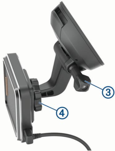
4 拧紧吸盘臂上的指旋螺钉和球形固定装置上的螺母。
