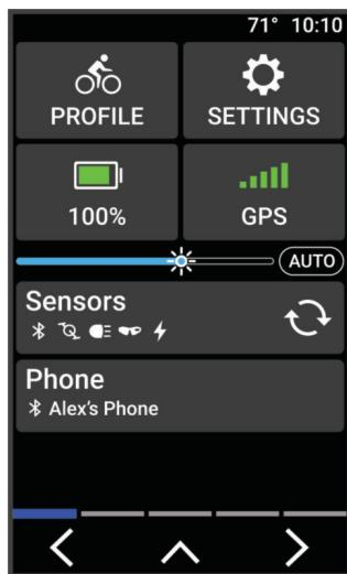
Das Status-Widget wird angezeigt. Wenn ein Icon blinkt, sucht das Gerät ein Signal. Wenn ein Symbol leuchtet, wurde das Signal gefunden oder der Sensor ist verbunden. Sie können ein beliebiges Symbol auswählen, um die Einstellungen zu ändern.
