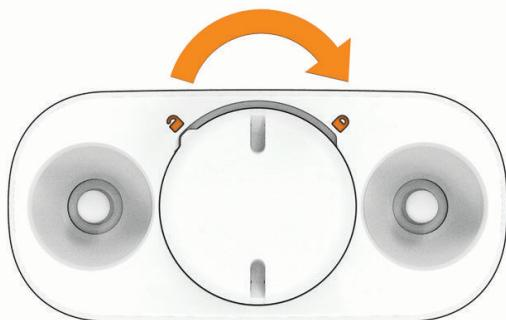
**9** Introduce la herramienta en las ranuras de la tapa y gira la cubierta a la derecha.
