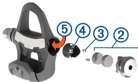
5. Con un destornillador Phillips pequeño (PH 00), retira los dos tornillos (3) del interior del soporte de las pilas (4).
