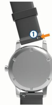
**2** Inserta un lado del perno de la nueva correa en el dispositivo.
