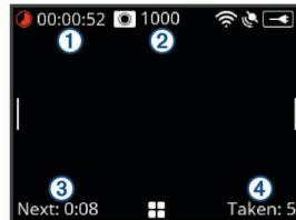
Камера сделает серию снимков с заданным интервалом времени. На экране отображается истекшее время ①, оставшееся количество фотографий ②, которое можно снять с помощью камеры, время в секундах до съемки следующей фотографии ③ и количество фотографий ④, сделанных с помощью камеры в рамках текущего сеанса покадровой съемки.
