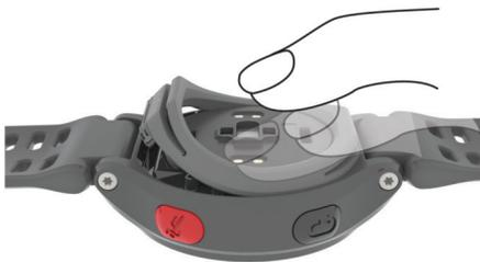
Zwischen der Lichtdichtung und der Rückseite des Geräts sollte kein Freiraum bestehen.
