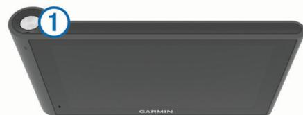
O dispositivo guarda uma fotografia e a gravação de vídeo antes, durante e depois de seleccionar a tecla. O LED pisca a vermelho enquanto o dispositivo está a guardar a gravação de vídeo.
