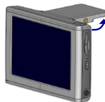
GPS-antenne opp (parallell med bakken)
