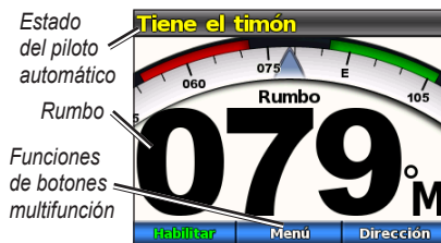
Pantalla Rumbo con el piloto automático en modo standby
